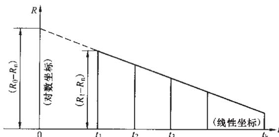
图 A.1 绕组温升测量计算  $R_0$  图
