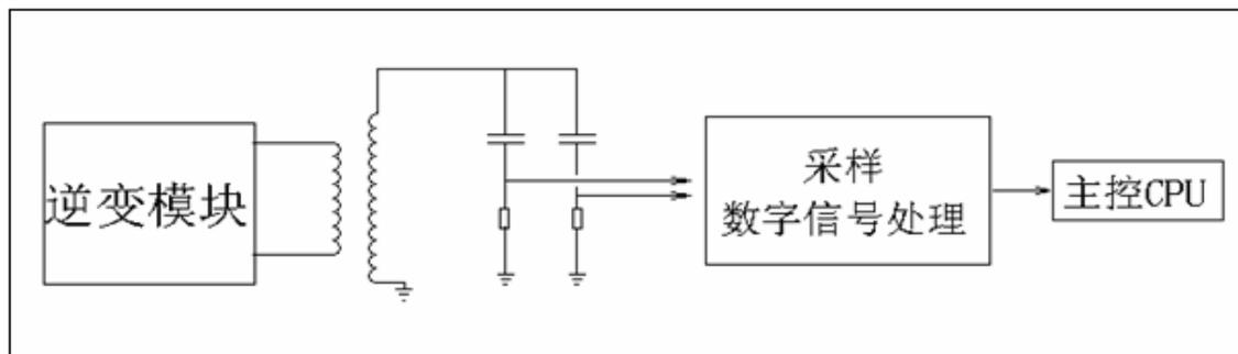
图四、介损测量原理图
