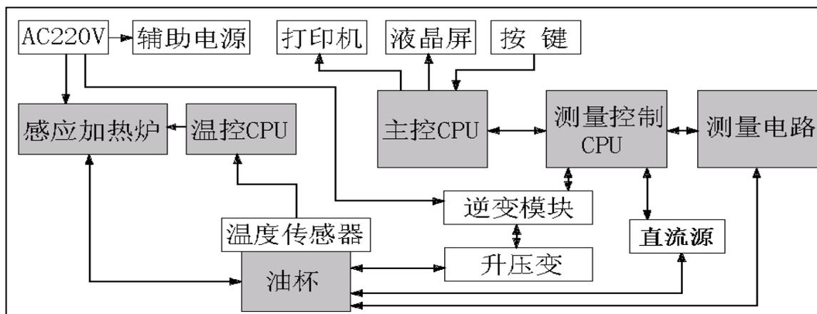
图三 仪器内部功能构造框图
