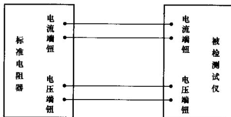
图 1 标准电阻法检定接线图
