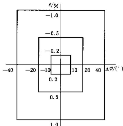
图 501 准确级为 0.2、0.5 和 1.0 的电容式电压互感器的误差图
