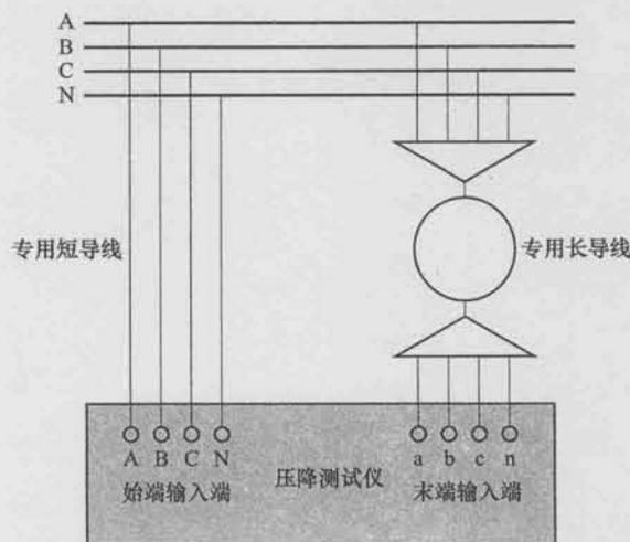
图 1 始端测量方式零位误差测试接线图
