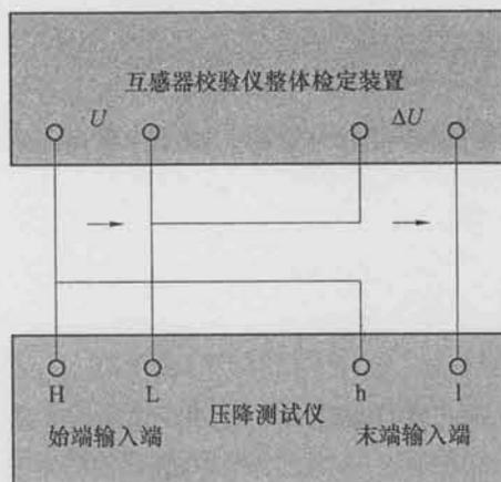
图 4 基本误差试验接线图
