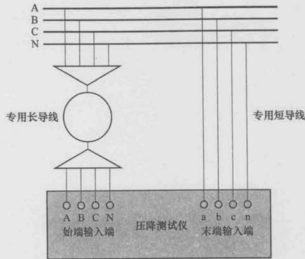
图2 末端测量方式零位误差测试接线图
