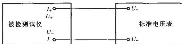
图 6 电流源空载电压检定原理图
